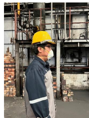
รูปที่ 62 พนักงานสวมใส่หน้ากากกันฝุ่นขณะเปลี่ยนอิฐทนไฟ
